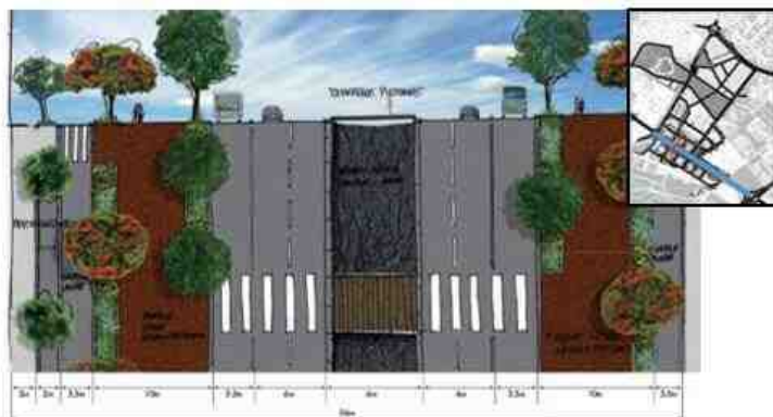
Figure 3 : Profil en travers proposé pour la RN7 (partie Ouest de notre périmètre)
